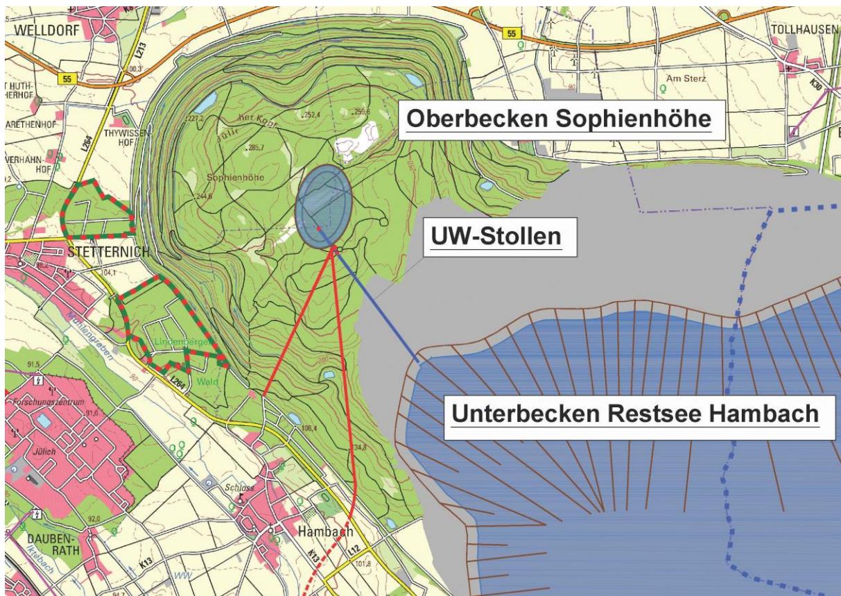
Abbildung 48: Lageplan für PSW-Variante 2.4 mit Restsee im aktuellen Tagebauloch
